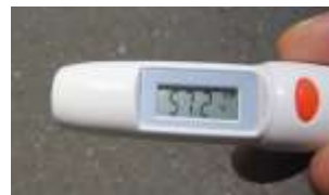
アスファルト道路面 日向 57.2℃
